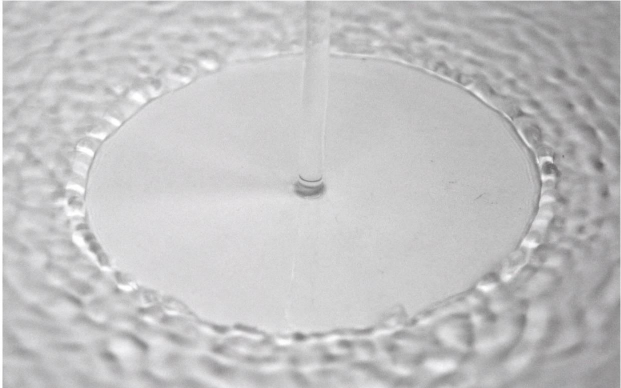
Avez-vous déjà remarqué le bourrelet qui se forme au fond de l'évier quand on ouvre un robinet ? C'est ce qu'on appelle un ressaut ou ressaut hydraulique : quand l'eau passe d'une zone d'écoulement rapide à une zone d'écoulement lent, il se produit comme un embouteillage qui crée le bourrelet.
