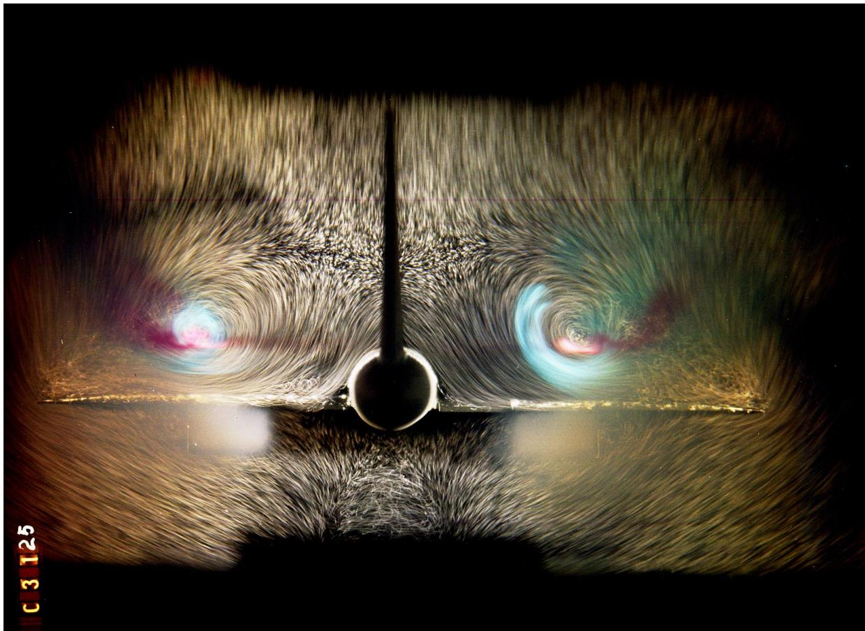
Visualisation en tunnel hydrodynamique des tourbillons d'extrados se formant sur une maquette de Concorde en configuration d'atterrisseage (plan transversal arrière). L'écoulement est rendu visible par des traceurs liquides colorés et des bulles d'air.
